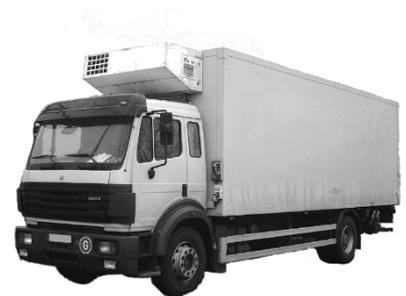
möglichst gering zu halten, müssen die Wände des Wagenkastens den Wärmestrom nach innen möglichst klein machen. Dafür muss ein geeigneter Dämmstoff verwendet werden.
